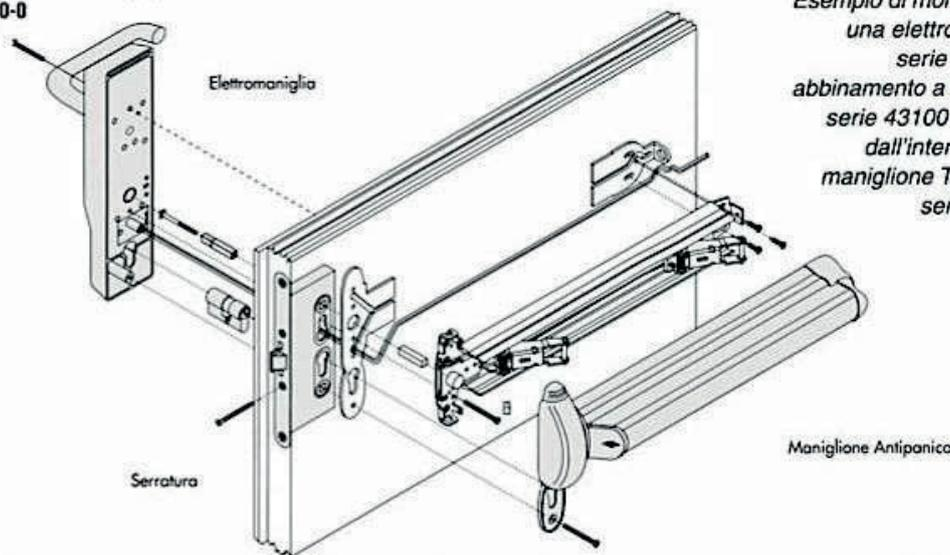
*Esempio di montaggio di una elettromaniglia serie 07074 in abbinamento a serratura serie 43100 azionata dall'interno da un maniglione Touch-bar serie 59710*
