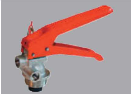
thread inlet syphon M 30 x 1,5 1/411 G M 16 x 1,5 cod. VALP3006
